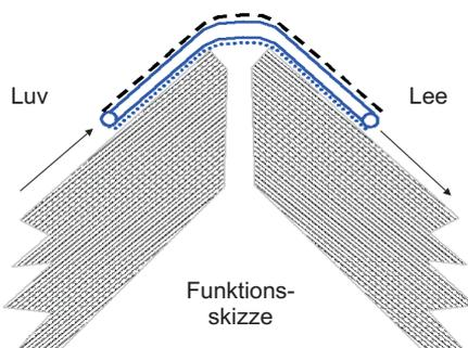
Die First Röhren-Lüfter-Matte kann unsichtbar unter vorhandene Papp-, Heidekraut- oder Grassodenfirste montiert werden.
